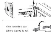
13. Dévissez l'axe de la charnière supérieure, tournez-la dans la charnière dans l'autre sens et fixez-y l'axe. Placez-la ensuite sur le côté pour l'utiliser.
