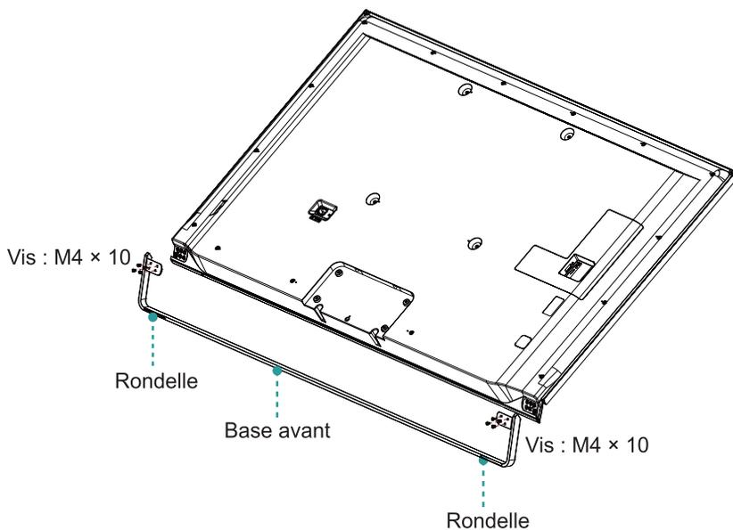
4. Retirez la base arrière, fixez-la au téléviseur à l'aide des 6 vis fournies dans le sac d'accessoires, puis fixez le couvercle (par aimantation).
