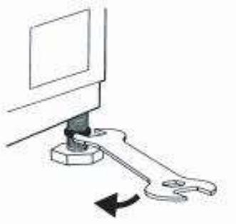
**Étape 2:** Soulevez légèrement la machine et ajustez la hauteur du pied, en le faisant pivoter.
